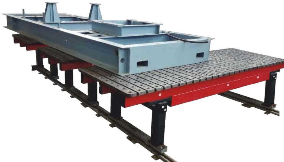
**СБОРОЧНО-СВАРОЧНЫЕ СТОЛЫ НА РЕЛЬСОВОМ ПУТИ ИМЕЮТ ШИРОКОЕ ПРИМЕНЕНИЕ В ИЗГОТОВЛЕНИИ КРУПНОГАБАРИТНЫХ МЕТАЛОКОНСТРУКЦИЙ ТИПА ФЕРМ, РАМ АВТОМОБИЛЕЙ, ВАГОНОВ, МОСТОВ, КРАНОВ И Д.Р.**
